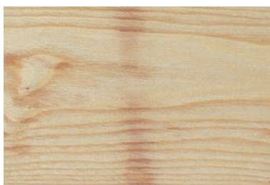
COLORACIÓN POR RASTREL: Color típicamente gris producido por rastreles utilizados para el secado de la madera.
