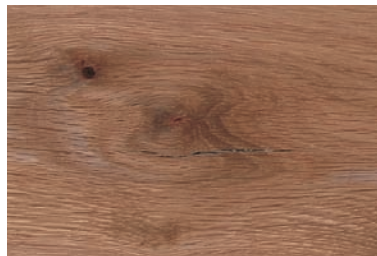
GRIETA: Abertura longitudinal en la cara de la tabla debida a un secado excesivamente rápido o defectuoso.
