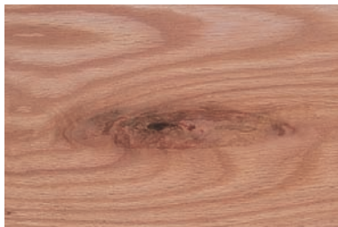
BOLSA DE CORTEZA: Es una distorsión del veteado relleno de corteza.
