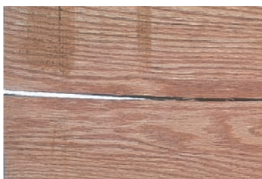
RAJADURA: Separación longitudinal en la madera generada durante su proceso de secado. Acebolladura es una separación entre los anillos de crecimiento anuales.
