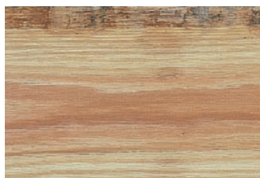
GEMA: Corteza o falta de madera debido a la forma cilíndrica natural del árbol o del tronco.
