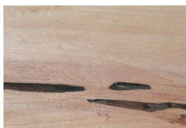
GALERÍAS DE LARVAS MAYORES: Orificios en la madera de más de \frac{1}{4} " de longitud.
