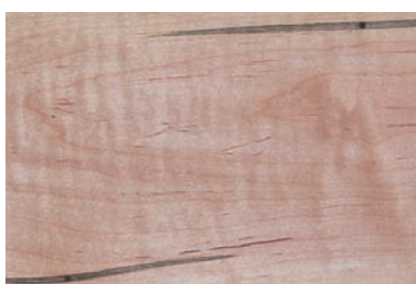
GALERÍAS DE LARVAS MENORES: Orificios en la madera cuya longitud varía de \frac{1}{16} " hasta \frac{1}{4} ".
