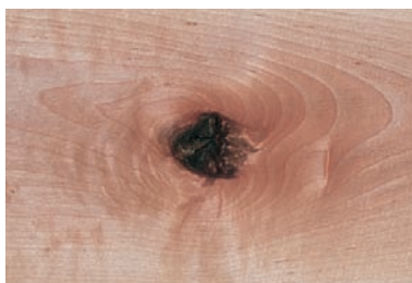
NUDO NO SANO: Zona circular que en un principio constituyó la base de una rama y que tiene un centro de médula. (En algunos casos la madera puede haber desaparecido).
